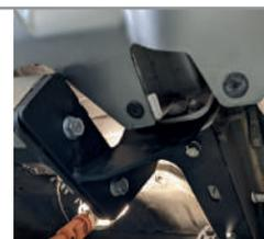
**ШАГ 4.** Наживите балку ТСУ на левый и правый кронштейны. Зафиксируйте положение балки, используя для крепления болты М12, шайбы 12 гроверные и шайбы 12. Затяните все соединения, отрегулировав положение ТСУ.
