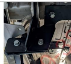
**ШАГ 5.** Установите на место тепловые отражатели, дефлекторы, глушитель на подушки и подключите датчик на штатной балке. Установите запасное колесо на место.
